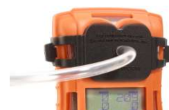
Płytki testu okresowego/kalibracji Do podawania gazu testowego do urządzenia T4
